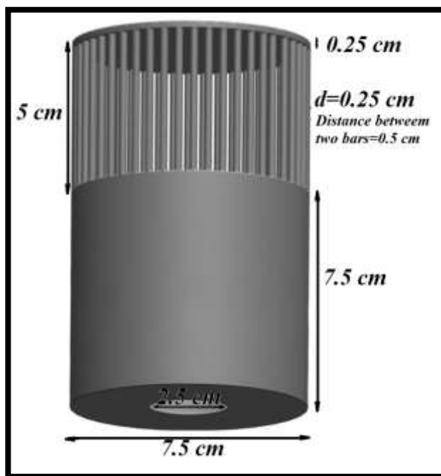
شکل ۲) هندسه و ابعاد سازه مدل آبیگر مورد مطالعه در این تحقیق (کوچک شده در مقیاس ۱:۴۰)
